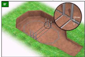
Une fois la tranchée périphérique faite, positionnez dans leur fouille les berceaux. Comblez avec du gravier de granulomètrie moyenne la tranché périphérique sur une hauteur d'environ 10 cm. Afin d'éviter un tassement qui se répercuterait sur la structure de la piscine, veillez à bien le compacter. Puis finissez de combier l'ensemble des tranchées avec un complément de sable mouillé que vous prendrez soin de compacter afin d'égaliser avec le
