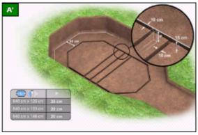
Profondeur de fouille : piscine semi-enterrée de hauteur 120cm = 58cm de hauteur 133cm = 65cm de hauteur 146cm = 70 cm Profondeur de fouille : piscine enterrée de hauteur 120cm = 116cm de hauteur 133cm = 129cm de hauteur 146cm = 142 cm
