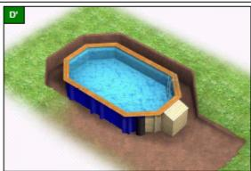
Réalisez la pose de la protection extérieure (film plastique spécial fondation non fournie) jusqu'à hauteur du futur rembial.
