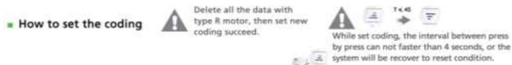
Effacer toutes les données en appuyant sur le bouton P2 situé à l'arrière de la télécommande, à côté de la batterie puis programmer le nouveau codage.
