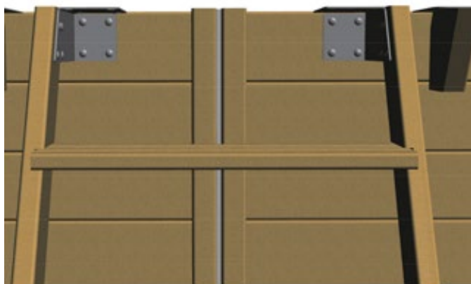
Figure 16 – Fixation de l'escalier extérieur sur le bassin
