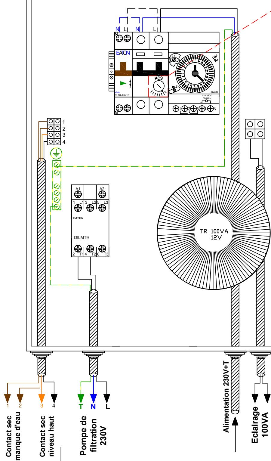
Raccordement pour option régulation de niveau.
