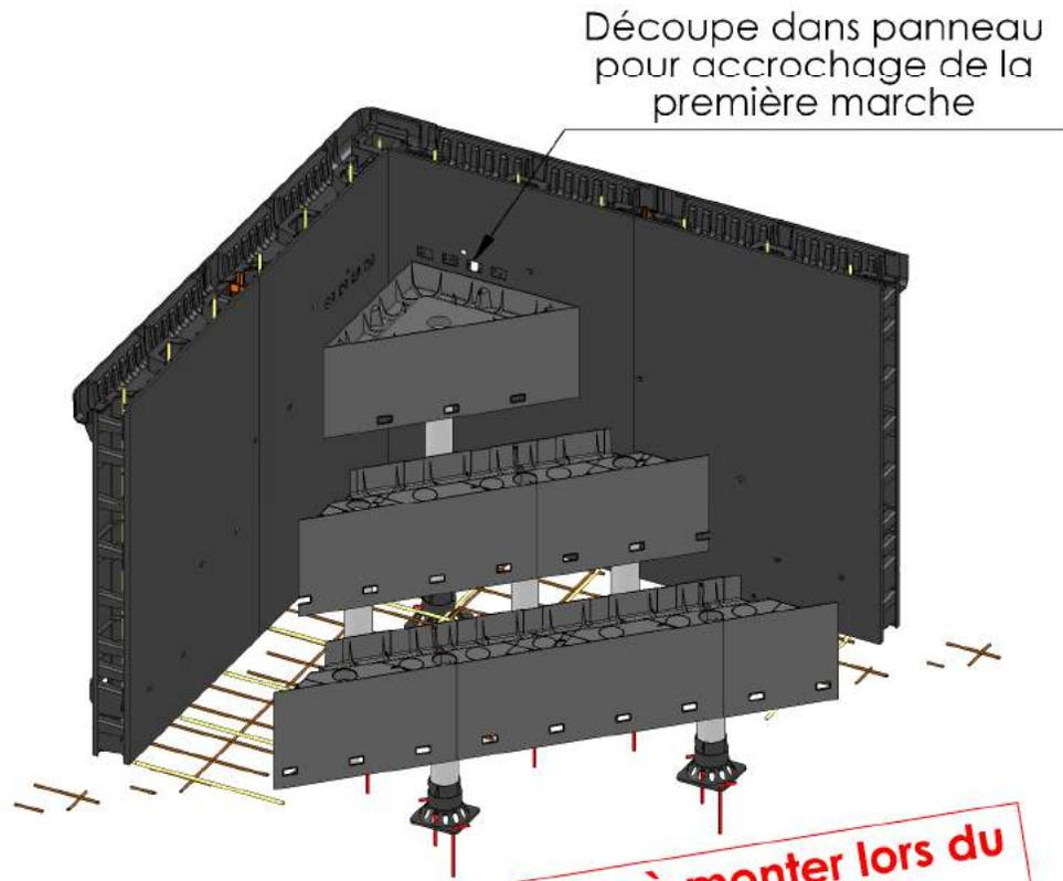
Percer les parois des panneaux avec un  $\phi 20\text{mm}$  et enfiler les aciers horizontaux  $\phi 10\text{mm}$  des coffrages de marche
