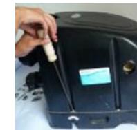
5. Dévisser l'écrou de l'entrée d'air si présente, ainsi que celui du connecteur du panneau de contrôle.
