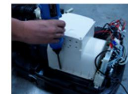
6. Dévisser les 4 vis du moteur jets, puis ôter le moteur en le levant.
