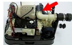
4. Puis accéder au circuit de puissance en dévissant les 4 vis du cache situé sur le dessus du moteur. **Ce circuit sera obligatoirement à remplacer en complément du moteur jets.** Déconnecter les fils en veillant à bien les repérer pour le remontage et démonter le circuit de puissance en retirant les 3 vis.
