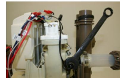
4. Retirer le joint de la sonde puis placer la sur la nouvelle sonde et effectuer les étapes dans le sens inverse.
