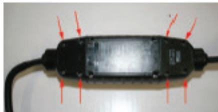
2. Déconnecter et retirer les câbles de chaque côté, en desserrant les vis de connexion, le serre câble et le presse étoupe.
