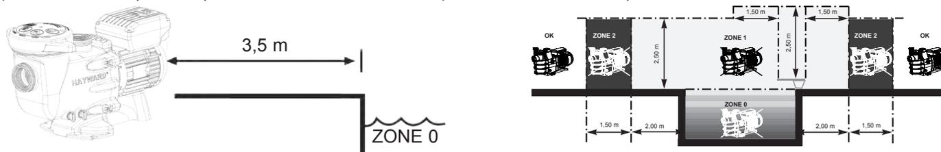
Installer la pompe dans un local ventilé et sec, le moteur exige que l'air circule librement autour de celle-ci pour permettre sa ventilation naturelle. Prévoir un dégagement minimum de 0,5 m autour de la pompe. Vérifier régulièrement que des objets, des feuilles ou tout autre encombrant ne viennent pas obstruer le refroidissement du moteur.
