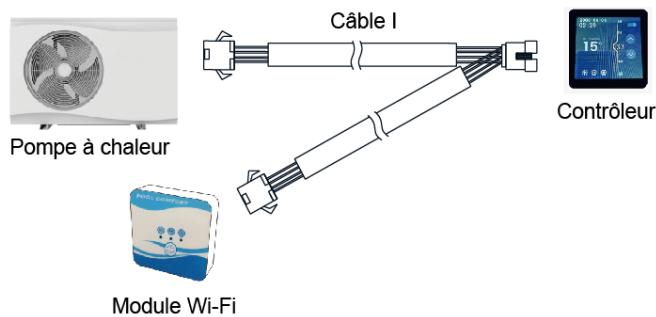
Veuillez débrancher le câble reliant le contrôleur et le circuit imprimé à travers les connecteurs. Le câble I (fiche femelle) est connecté avec le câble du circuit imprimé. Les fiches males du câble 1 sont connectés au contrôleur et au module Wi-Fi.
