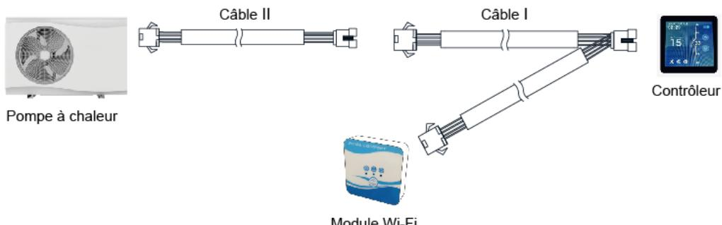
Veuillez débrancher le câble reliant le contrôleur et le circuit imprimé à travers les connecteurs. Le câble I (fiche femelle) est connecté avec le câble du circuit imprimé.
