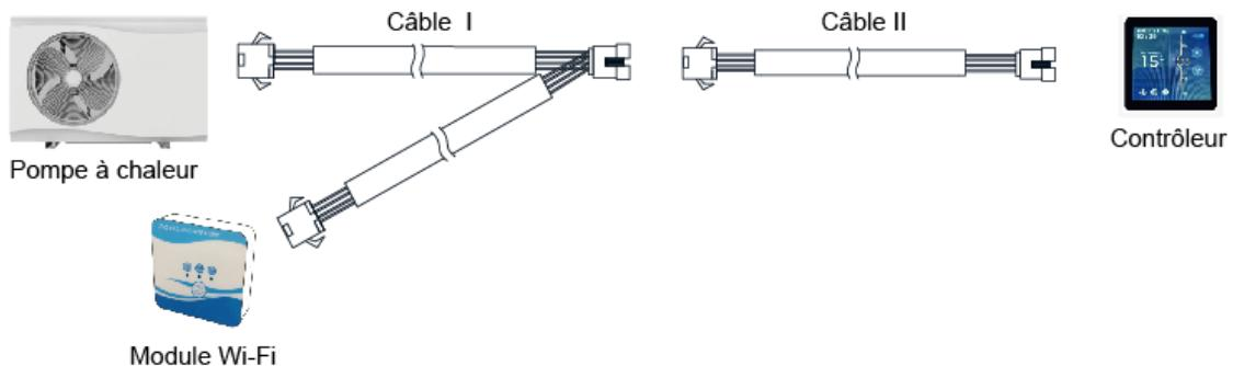
Veuillez débrancher le câble reliant le contrôleur et le circuit imprimé à travers les connecteurs. Le câble II (15m) est connecté avec le câble du circuit imprimé et au câble 1. Le câble 1 est connecté au contrôleur et au module Wifi.
