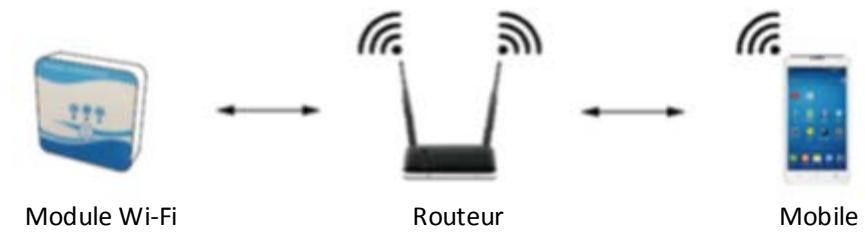
Mettez la pompe à chaleur en marche, les voyants d'alimentation et de communication sur le module Wi-Fi s'allument. Appuyez sur le bouton de configuration pendant 3 secondes. Lorsque le voyant Wi-Fi continue à clignoter, cliquez sur le bouton « Confirm indicator rapidly blink ».
