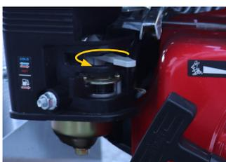
2. Positionner le levier du starter de démarrage à gauche. L'utilisation du starter n'est pas requis quand le moteur est chaud ou quand la température est élevée.
