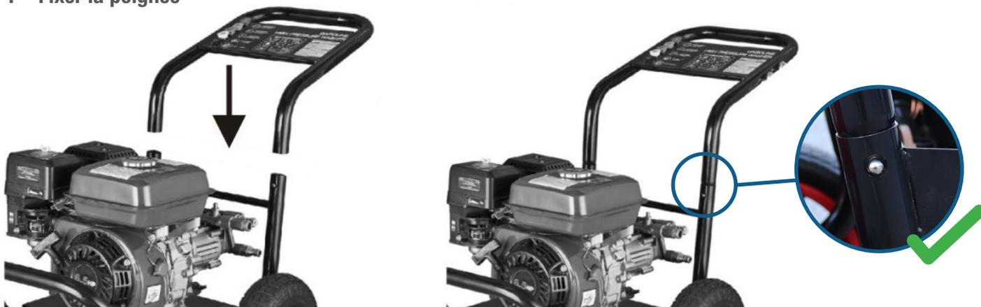
Insérer les 2 tubes jusqu'à ce que les butées ressortent correctement.
