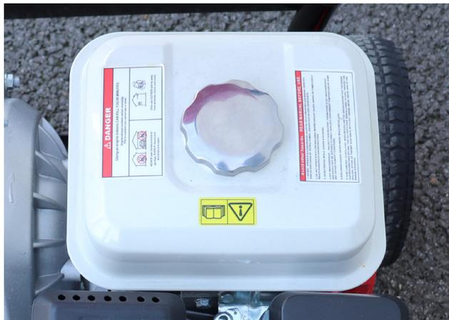
Ouvrir le bouchon et remplir le réservoir à l'aide d'un entonnoir.
