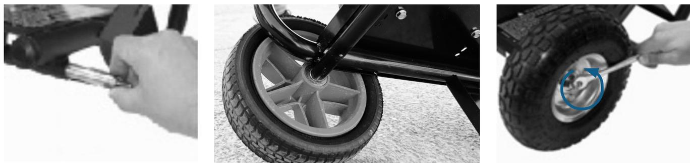
Mettre le chariot en position verticale, insérer l'essieu jusqu'à ce que la butée ressorte correctement. Puis serrer l'écrou de la roue. Et recommencer pour la seconde roue.
