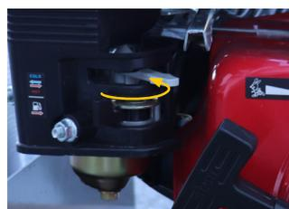
6. Laisser tourner le moteur au ralenti un court instant pour préchauffer le moteur puis positionner le levier du starter de démarrage à droite
