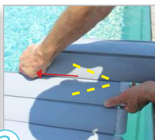
2 Relever les lames et donner un mouvement vers l'intérieur (faire un «V») de manière à emboîter les 2 modules
