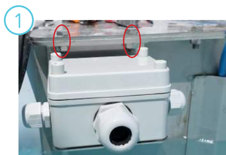
1 Fixer le support du boîtier de connexion sur la flasque (extrémité, côté mur de fond) à l'aide des vis et des boulons
