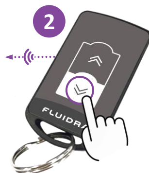
Appui jusqu'à arrêt du clignotement → Appairage terminé.
