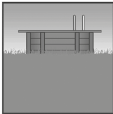
Installation semi-enterrée (sur dalle béton) ATTENTION : Dispositif de sécurité obligatoire (bâche, alarme, barrière...)
