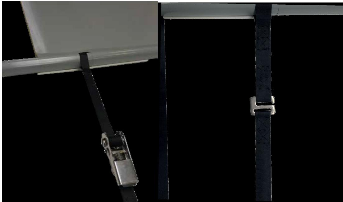
8. Après la mise en place des pitons, accrocher les cliquets à l'aide de leur anneau et tendre la bâche pour une mise en sécurité de la piscine.
