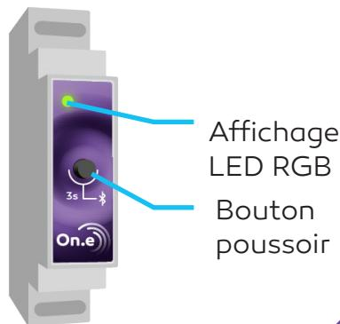
Depuis le produit, chaque pression exercée sur le bouton poussoir provoque le changement du mode de fonctionnement : ON, OFF, HORLOGE, ON...
