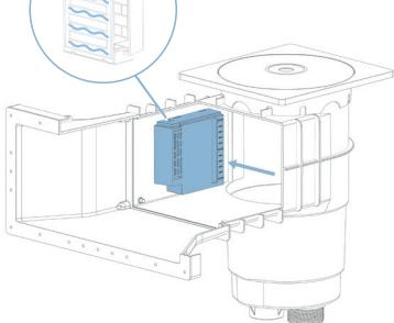
**Fixez le CAPTEUR DE NIVEAU dans le boîtier du skimmer à l'aide d'un mastic spécial piscine** (ex. : GRIFFON Aqua Max / AXON MS 3000 Pro) ou d'une colle pour ABS (ex. : Welticolle – prise définitive).
