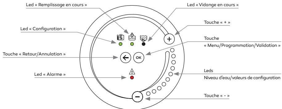
Ces trois Leds «**configuration**», «**remplissage**» et «**vidange**» permettent aussi d'identifier les différentes **choix** de configuration, voir ci-dessous.
