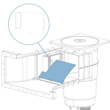
**Découpez le volet existant du skimmer** afin de permettre le passage du CAPTEUR DE NIVEAU tout en conservant le mouvement du volet.
