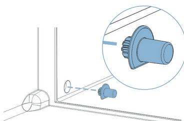
Les axes de rotation du volet permettent d'installer le KIT SUPPORT dans le skimmer. Sur certains skimmers, les axes de rotation sont intégrés au volet. Dans le cas contraire, insérer les axes adaptables dans les cavités du skimmer (plusieurs tailles à disposition) pour pouvoir installer le kit. Pour une meilleure durabilité, collez les axes dans les cavités.
