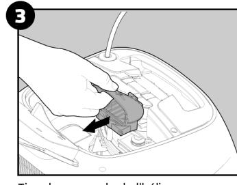
Tirez le couvercle de l'hélice vers l'arrière pour le dégager. Enlevez les déchets qui encombrent l'hélice. Réassemblez le couvercle de l'hélice.
