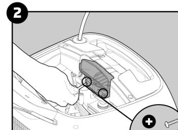
Au moyen d'un tournevis court, desserrez les 2 vis.
