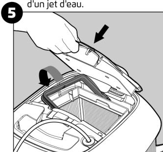
Réinsérez l'assemblage de filtration nettoyé et fermez le couvercle.
