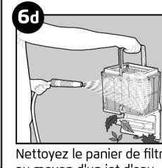
Nettoyez le panier de filtration au moyen d'un jet d'eau.
